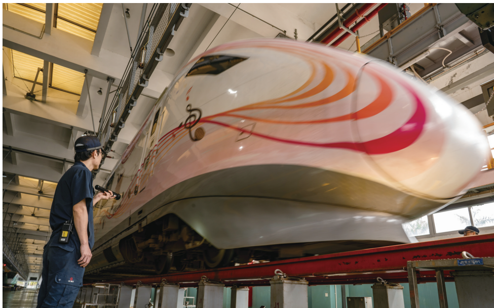
检修完的列车准备出库,机械师做最后的聆听检查。
