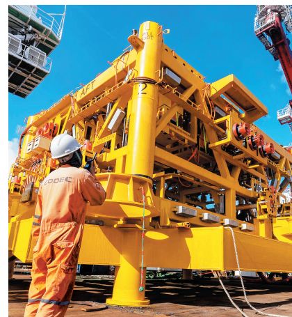
▲工作人员检查深水水下中心管汇。 ◀“深海一号”二期项目所用深水水下中心管汇入水瞬间。(中海油供图)
