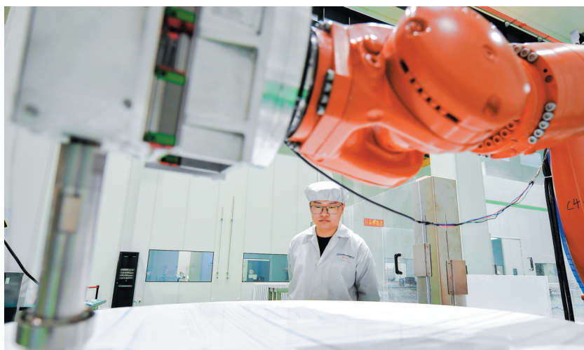
科研人员利用智能机器人研抛平台加工光学反射镜(4月3日摄)。新华社记者 许畅 摄
