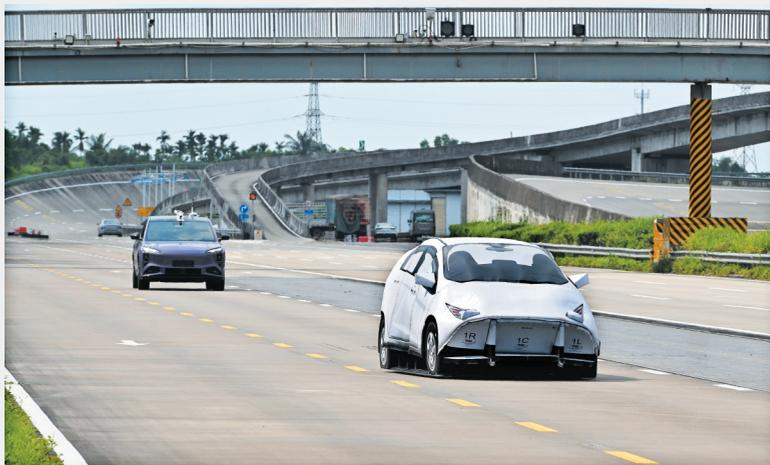
■ 自动紧急制动系统测试
