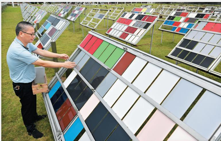
■ 汽车油漆材料曝晒试验
