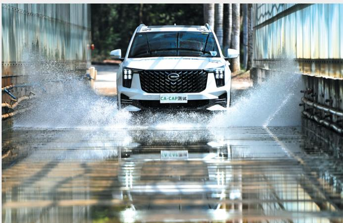
■ 盐水腐蚀试验
