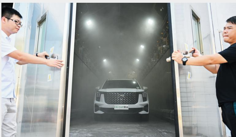
■ 盐雾腐蚀试验
