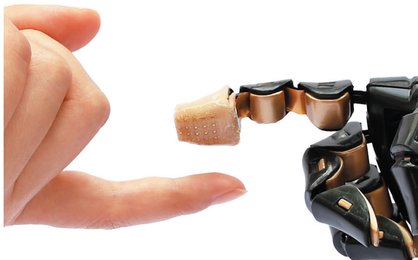
装有仿生三维电子皮肤的机械手与人手互动。(据新华社视点微信公众号)
