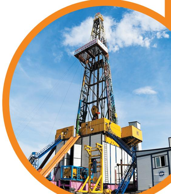
“地壳一号”万米钻机整机系统。
