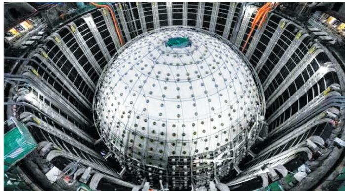
江门中微子实验的核心探测设备——中心探测器。(来源:央视新闻)
