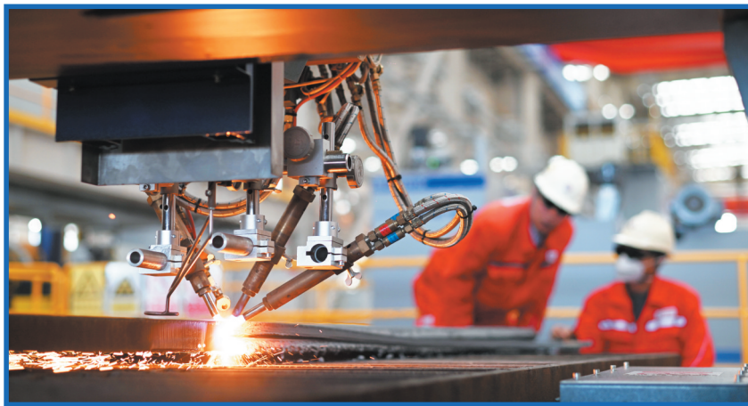
工作人员在海油工程天津智能制造基地制管作业车间调试数控切板机(新华社发)
