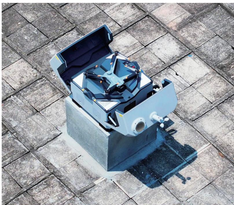
无人机巢接到指令后，无人机将自动起飞对预定线路进行巡视。
