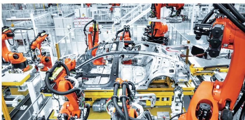
这是位于合肥市肥西县的江淮汽车蔚来超级工厂内的自动化焊接生产线。新华社发
