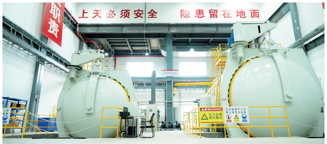
海航技术复合材料工艺中心的超大口径固化成型设备。记者 吴多圣 摄
