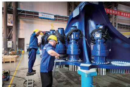
工作人员给偏航驱动装置做螺栓紧固。
